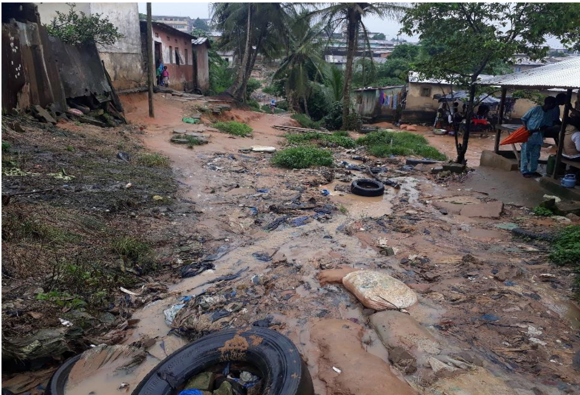
Photo 46 : Absence d'ouvrage d'assainissement, provoquant des érosions en saison pluvieuse à Anyama (Source : Notre enquête, 2018)
